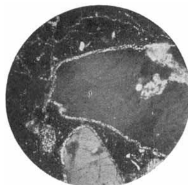
Abb. 19. Dünnschliff aus durch Sulfatwirkung zerstörtem Beton: Die Neubildung hat sich in erster Linie gebildet an den Grenzflächen Sandkorn—Zementleim.
