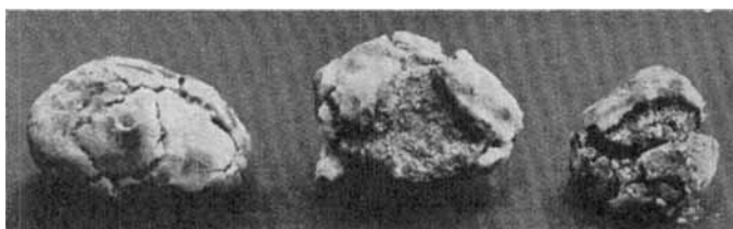
Abb. 15. Während 4 Monaten in Ammoniumsulfat gelagerte Klinkerkörner ( \frac{1}{2} der natürlichen Größe): Die Klinkerkörner haben angefangen zu treiben, ein Beweis, daß auch in Beton ein Treiben des noch unhydratisierten Zementes erwartet werden und zu Zerstörungen führen kann.
